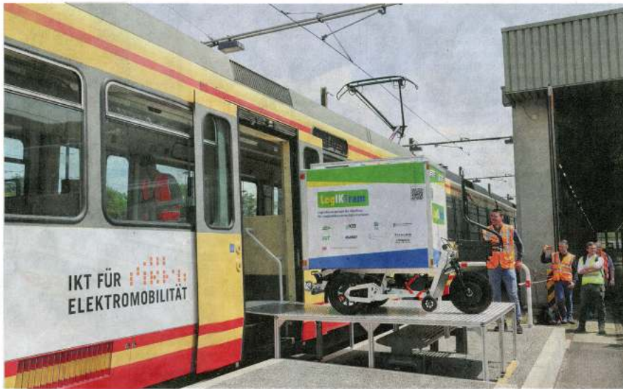
Die letzten paar Meter soll der Fahrradanhänger alleine in die Bahn zurücklegen. Der Fahrweg ist programmiert. Künftig könnte der Anhänger auch mit Sensoren versehen sein, so dass er komplett autonom seinen Weg findet. Foto: Jörg Donecker
